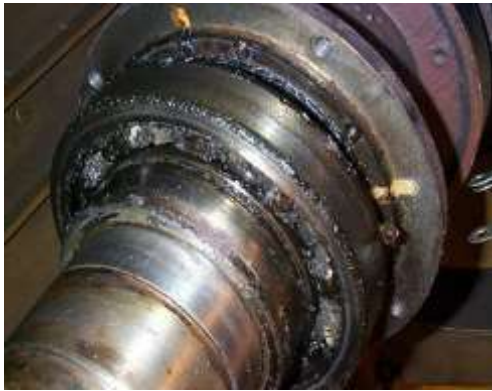
Fig. 2 - Rodamientos fallados por sobreengrase
