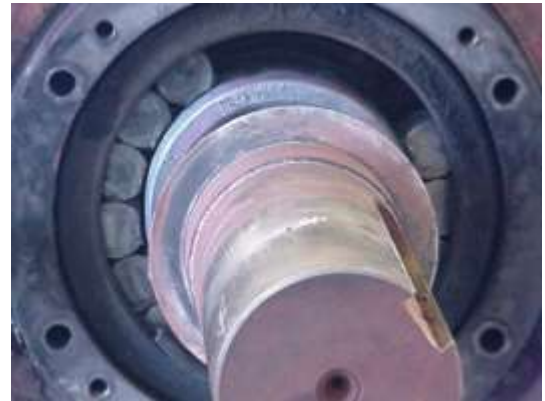
Fig. 4 - Rodamiento con falla por falta de grasa
