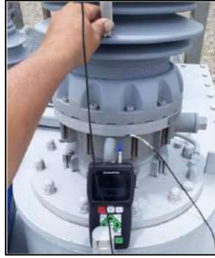
Figura 9. Medición de espesor de capa seca
