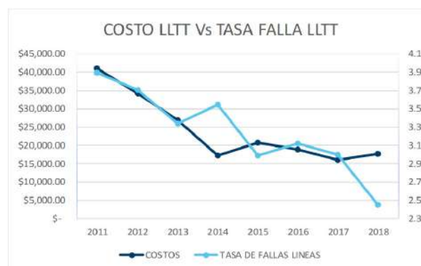
Figura 8. Costo mto (Millones de pesos) vs tasa de fallas en cada 100 km. de línea INTERCOLOMBIA
