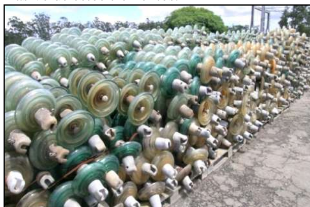
Foto 1. Descarte masivo de aisladores corroidos desmontados de una línea de transmisión de energía.
