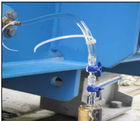
Foto 7. Toma de muestra de aceite para control de sulfuros corrosivos.
