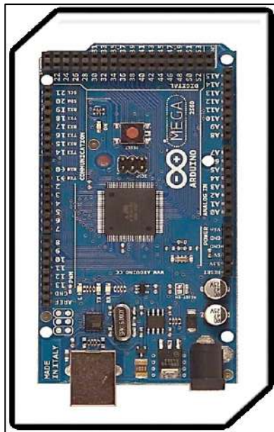
Ilustración 10 - Circuito Controlador Arduino Simulator
