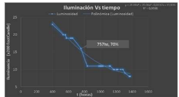
Ilustración 16 - Fallas en las bombillas de frenado
